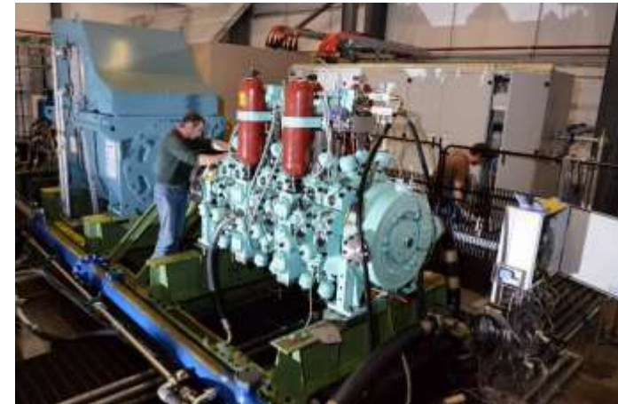
'H201': 3.5 MW, 1000 rpm
